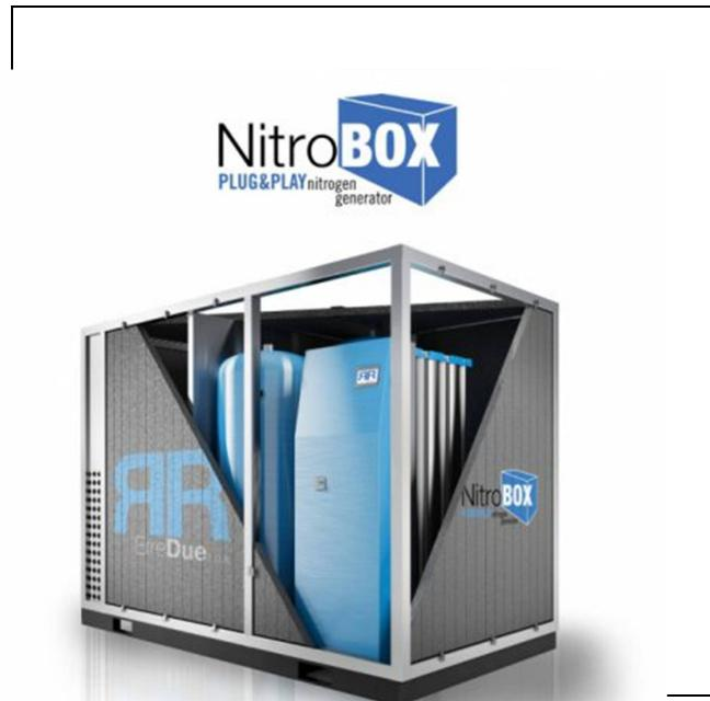
I prodotti della serie NITROBOX sono capaci di produrre autonomamente l'azoto necessario al taglio, riempiendo il serbatoio integrato a 40bar di pressione oppure bombole a 200 e 300 bar; da questo serbatoio, l'azoto viene convogliato direttamente al sistema laser, con flussi fino a 500 Nmc/giorno ovvero, in uno o più serbatoi per la conservazione di tale gas pressurizzato.
